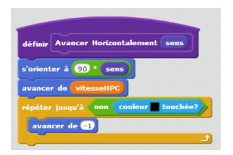
Dans ce bloc, nous orientons le cube à droite ou à gauche suivant la valeur de « sens »
