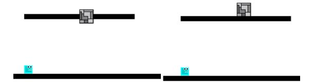
En effet, une fois la demande de saut émise, la vitesse du cube à la verticale devient positive et si le plateau au dessus est suffisament près, rien n'empêche le cube de le traverser puisque sa coordonnée « y » est brutalement augmentée.
